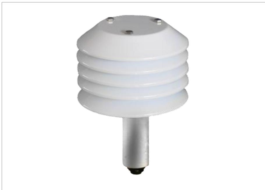
Il sensore per la misura della Temperatura è costituito da una termoresistenza al Platino Pt100 (da 100 Ω a 0°C), sensibile alla variazione di temperatura secondo le norme DIN 437601/3DIN. L'elemento sensibile è protetto da una serie di schermi contro la luce diretta del sole e le radiazioni UV, disposti in modo da garantire una ventilazione naturale.
