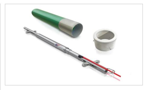
La sonda estenso-inclinometrica fissa è progettata per effettuare misure plano-altimetriche all'interno di tubi esteno-inclinometrici, installata a profondità predeterminate.
