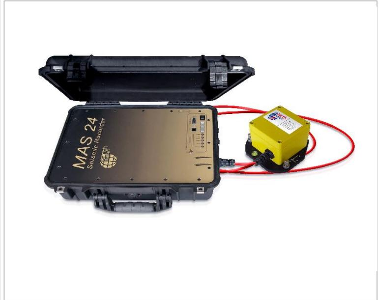
L'unità integrata ad alta risoluzione (campionamento a 24 bit e dinamica > 130 db) da 3 o 6 canali può funzionare come unità di acquisizione dati vibrazionale o sismica/microsismica in conformità con le normative internazionali applicabili DIN4150-3, DIN45669-1 e UNI9916.
