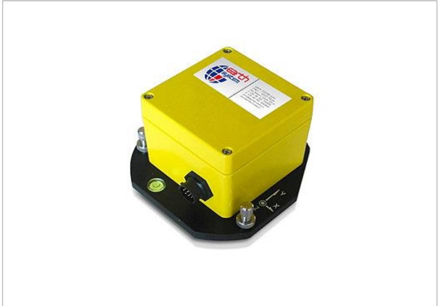
Velocimetro di classe 1, per misure di vibrazioni secondo DIN4150-3, DIN45669-1, UNI9916 e UNI9614. Geofoni linearizzati elet-tronicamente, con dinamica > 130 dB. Prodotto in due versioni per applicazioni verticali o orizzontali e nelle versioni triassiale, biassiale e uniassiale. È alloggiato in una robusta custodia in metallo (IP67) ed è dotato
