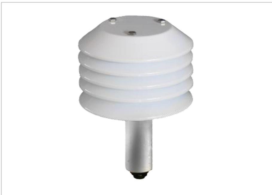
Il sensore combinato per la misura della Temperatura e Umidità dell'Aria UTA, è costituito da una termoresistenza al Platino Pt100 (da 100 Ω a 0°C), sensibile alla variazione di temperatura secondo le norme DIN 437601/3DIN. L'elemento sensibile è protetto da una serie di schermi contro la luce diretta del sole e le radiazioni UV, disposti in modo da garantire una ventilazione naturale. Il loro particolare colore bianco riflettente, annulla l'effetto di
