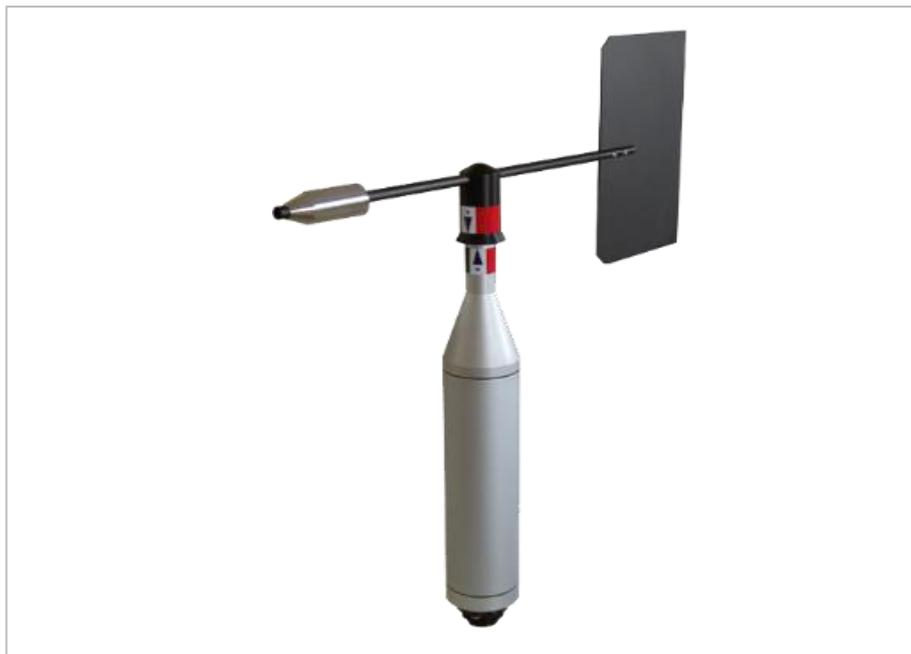
Il sensore per la misura della direzione del vento (Gonio-anemometro), è realizzato con materiali ad alta affidabilità e durata, che mantengono a lungo le caratteristiche di sensibilità e precisione. La robustezza meccanica consente al sensore di resistere a venti di forte intensità e ad improvvise raffiche (fino a 300km/h). L'utilizzo di uno speciale encoder magnetico assicura un'elevatissima risoluzione e precisione eliminando ogni attrito meccanico in un angolo operativo completo di 360°.
