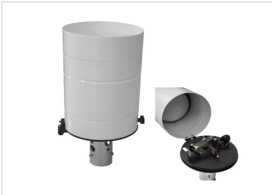
Il pluviometro è costituito da un corpo cilindrico in alluminio con una superficie di raccolta di 400 cm<sup>2</sup> dentro il quale viene montato un orifizio di raccolta a forma di imbuto che attraverso un filtro convoglia il precipitato verso una bascula in acciaio inox realizzata con un sistema di appoggio a lama di coltello.
