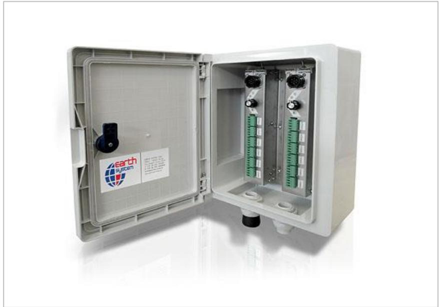
Il pannello di centralizzazione e misura consente di raccogliere più cavi strumentali in un unico punto di misura. E' custodito in un armadio di materiale plastico con chiusura a pannello frontale cieco. Ciascun pannello può raccogliere fino a 6 cavi strumentali a 2, 3, 4 o 6 conduttori. La misura avviene in modo rapido
