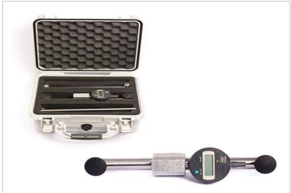
Il deformometro meccanico è uno strumento di misura adatto per valutare le variazioni di distanza (spostamento relativo) tra due basi di lettura, con un ordine di grandezza di un millesimo di millimetro.
