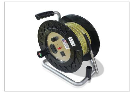
Il sondino di livello o freatimetro viene utilizzato per la misura del livello di falda all'interno di piezometri tubo aperto, piezometri Casagrande, pozzi irrigui, per la misura del livello idrometrico in canali, laghi e invasi. E' composto da un rullo di plastica montato su un telaio in acciaio. Il cavo di segnale graduato è avvolto sul rullo che può avere una sezione tonda o piatta e
