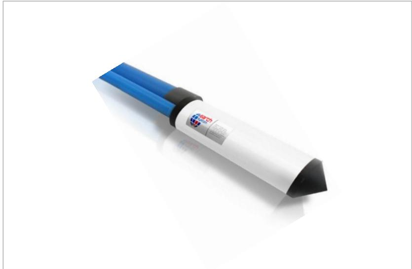
La cella 'Casagrande' è costituita da un elemento filtrante cilindrico in polietilene sinterizzato con porosità di 50 micron, che consente all'acqua di penetrare all'interno, un terminale inferiore conico ed un terminale superiore con raccordi filettati femmina per l'attacco di tubi piezometrici.
