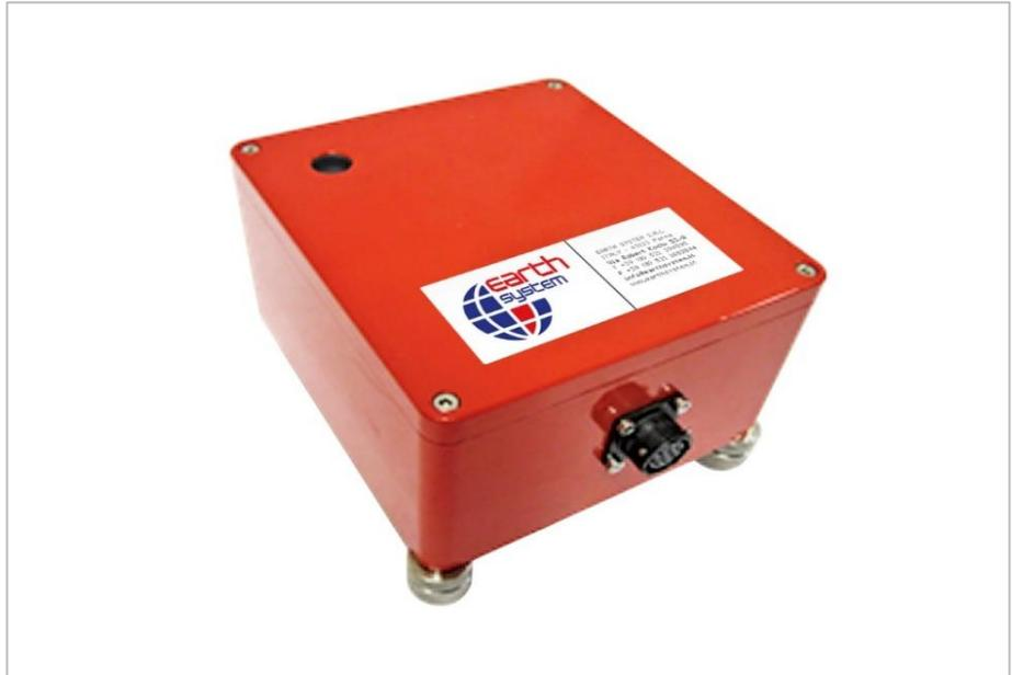
Gli accelerometri Force balance sono sensori ad alta sensibilità ed a basso rumore progettati per lo studio di movimento sismico di basso livello a bassa frequenza. Gli accelerometri sono autonomi e forniscono un'uscita di alto livello e bassa impedenza. Nessun condizionamento del segnale è richiesto nella maggior parte delle applicazioni. Questi sensori utilizzano componenti elettronici a basso rumore in combinazione con il principio del bilanciamento della forza per effettuare
